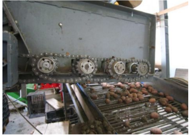
Lánchajtások védőburkolatok nélkül
