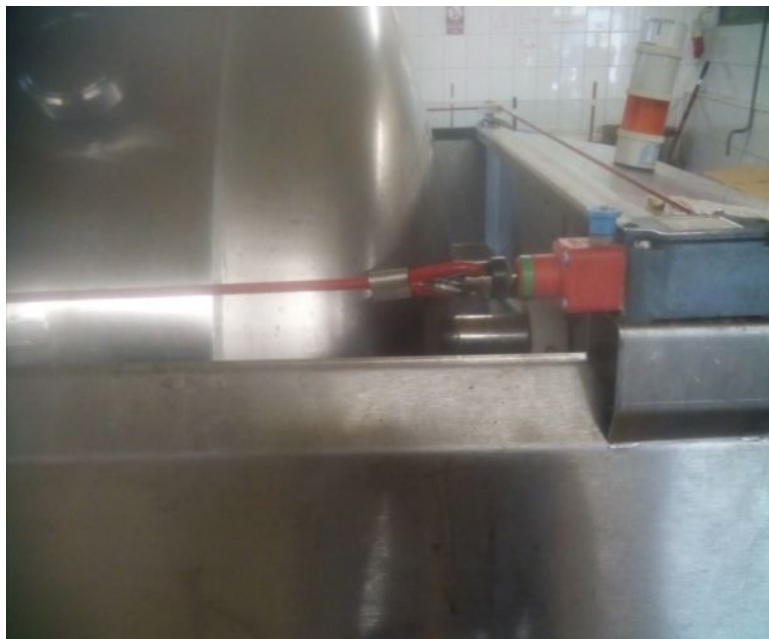
Pneumatikus szőlőprés, vész-zsinórral és az üzemelést jelző lámpával ellátva
