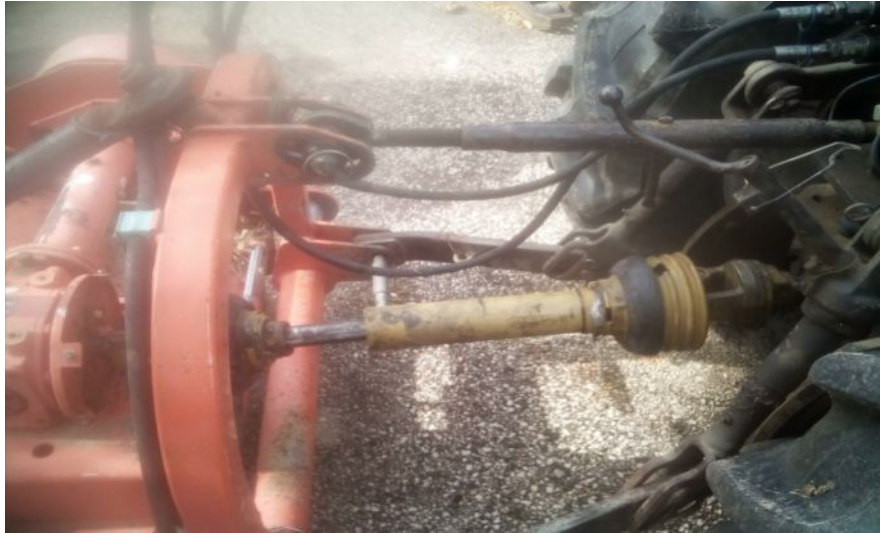
Mezőgazdasági traktor kardántengely burkolata törött, hiányos, biztosító láncsal nincs ellátva
