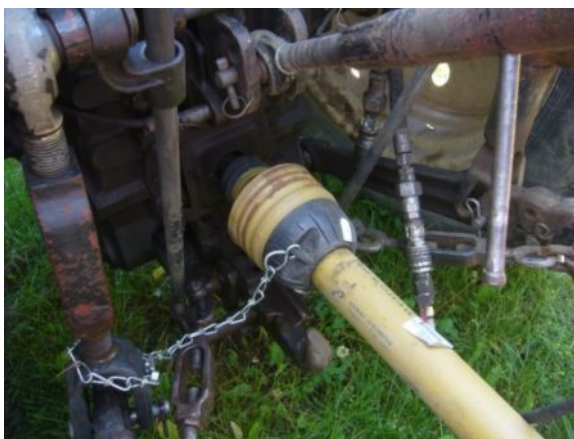
Traktorok kardántengelyei szabályos védőburkolattal ellátva
