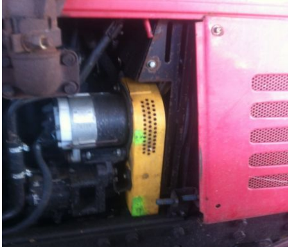
Mezőgazdasági erőgép generátor ékszíjhajtása védőburkolattal ellátva
