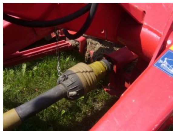
Traktorok kardántengelyei szabályos védőburkolattal ellátva
