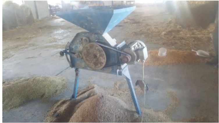
Terménydaráló meghajtását biztosító ékszij és ékszijtárcsák nem rendelkeztek védőburkolattal
