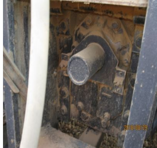
Teljesítmény leadó tengely védőburkolattal ellátva
