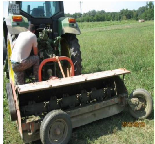
Burkolatlan ékszijhajtás a szártépő adapteren
