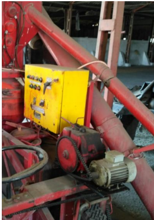
Csávázógép villanymotor lánchajtását nem fedi védőburkolat
