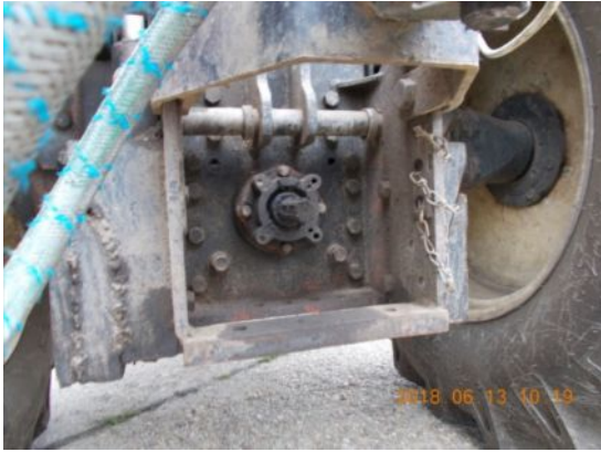
A mezőgazdasági erőgép teljesítmény-leadó tengelyvég burkolata hiányzott
