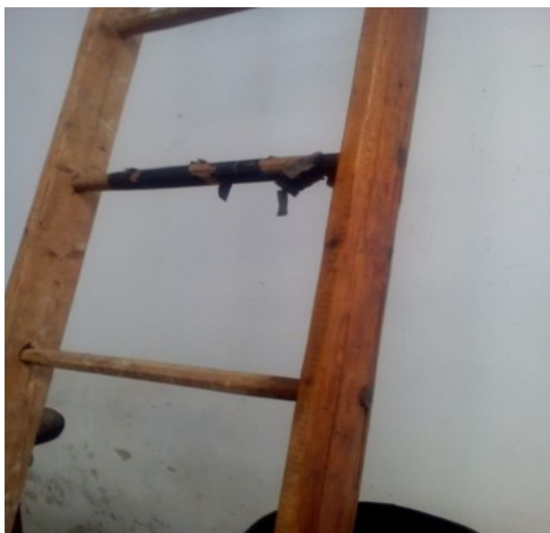
A 14 fokos támasztó létra lépcsőfoka repedt, sérült volt, szigetelőszalaggal javították
