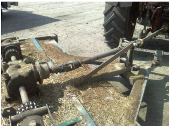
Kardántengelyek védőburkolatok nélkül
