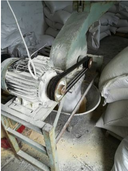
Terménydaráló meghajtását biztosító ékszij és ékszijtárcsák nem rendelkeztek védőburkolattal
