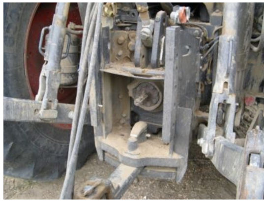
A mezőgazdasági erőgép teljesítmény-leadó tengelyvég burkolata hiányzott
