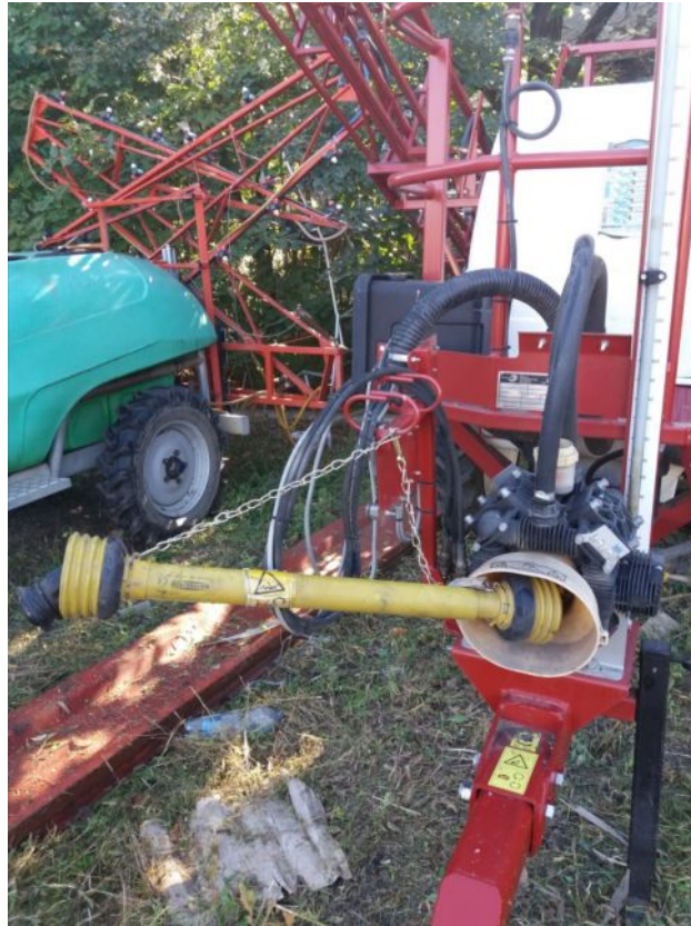
Permetezőgép kardántengelye szabályos védőburkolattal ellátva
