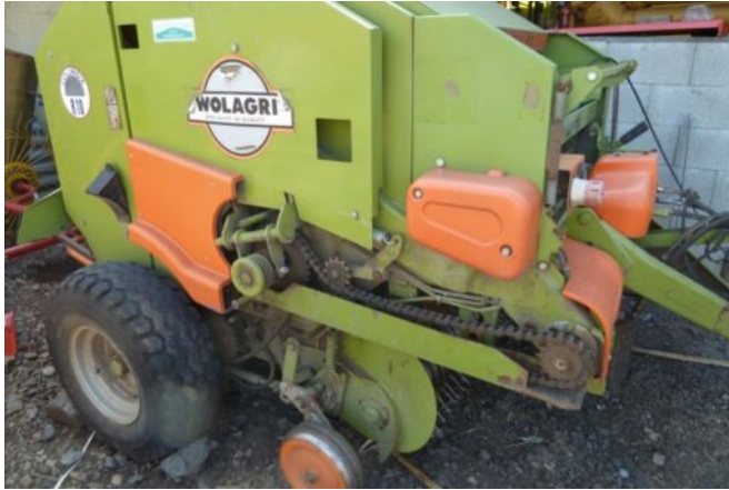
Lánchajtások védőburkolatok nélkül
