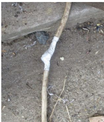
Sérült, illetve nem megfelelően javított villamos vezetékek és aljzatok
