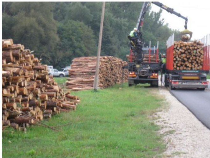
Erdészetben faanyag rakodás erdészeti daruval tehergépjárműre
